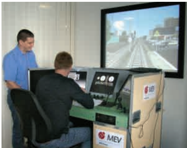
Simulator für verschiedene Level des ETCS.
